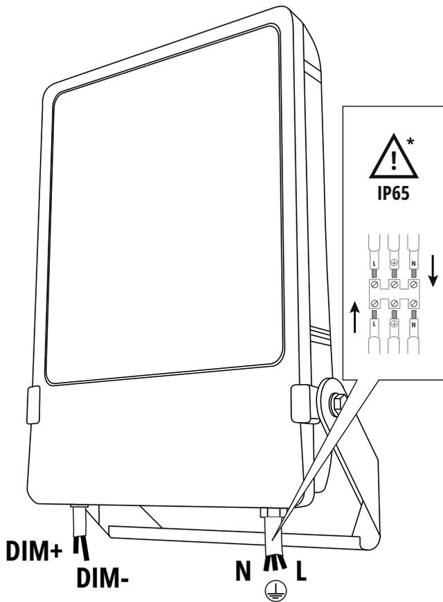
**\* Kostka zaciskowa nie jest dostarczana. Instalacja musi być wykonana przez osobę wykwalifikowaną. Wymagany jest dobór kostki zaciskowej uwzględniającej stopień szczelności oprawy i przekrój przewodów przyłączeniowych.**
