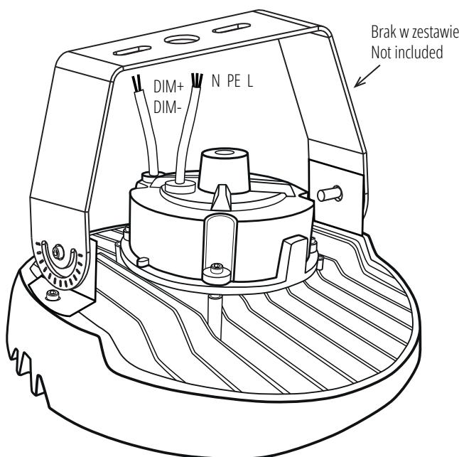
**Kostka zaciskowa nie jest dostarczana. Instalacja musi być wykonana przez osobę wykwalifikowaną. Wymagany jest dobór kostki zaciskowej uwzględniającej stopień szczelności oprawy i przekrój przewodów przyłączeniowych.**
