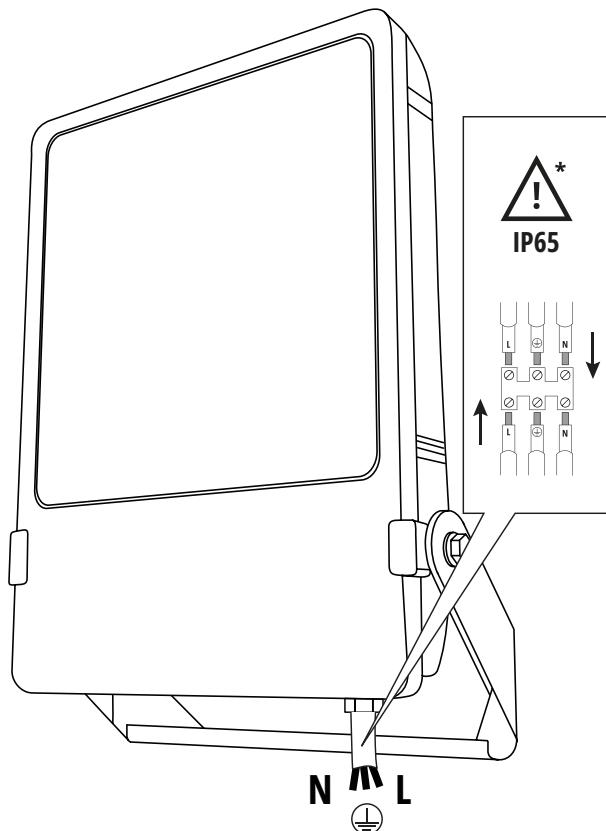
**\* Kostka zaciskowa nie jest dostarczana. Instalacja musi być wykonywana przez osobę wykwalifikowaną. Wymagany jest dobór kostki zaciskowej uwzględniającej stopień szczelności oprawy i przekrój przewodów przyłączeniowych.**
